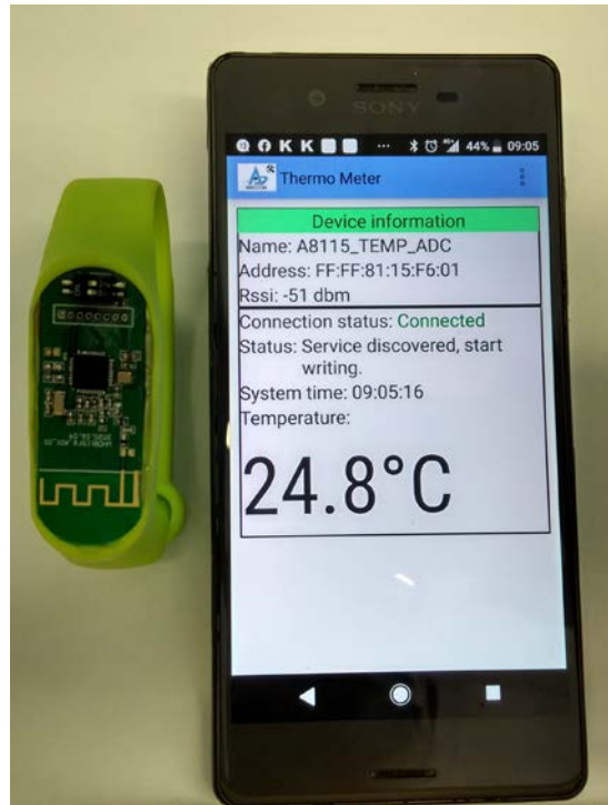
Fig12: 環境溫度透過 A8115F6 BLE Temp Sensor，在手機 APP 顯示
